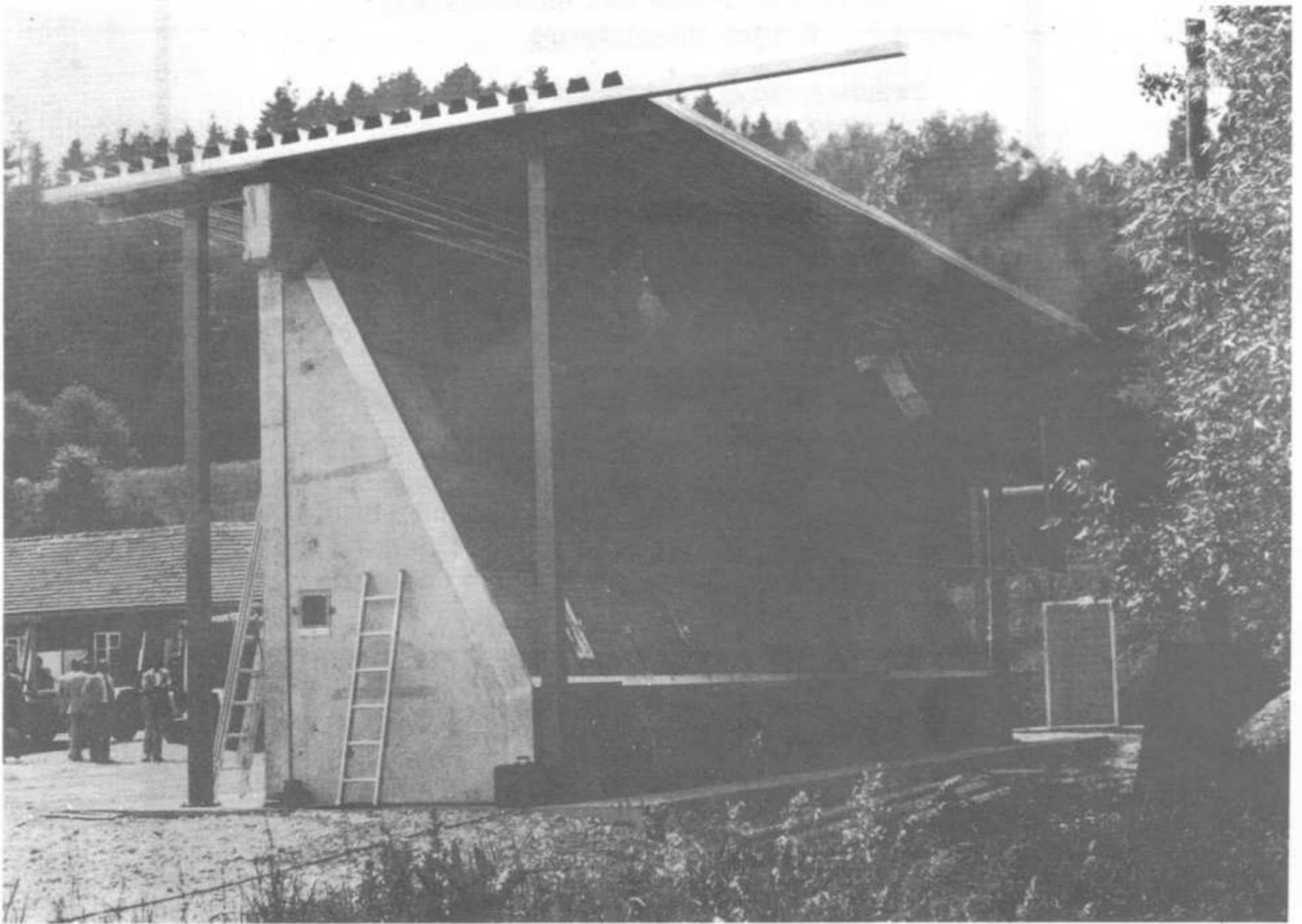
*Unser neuer Großprüfstand für Brandversuche
